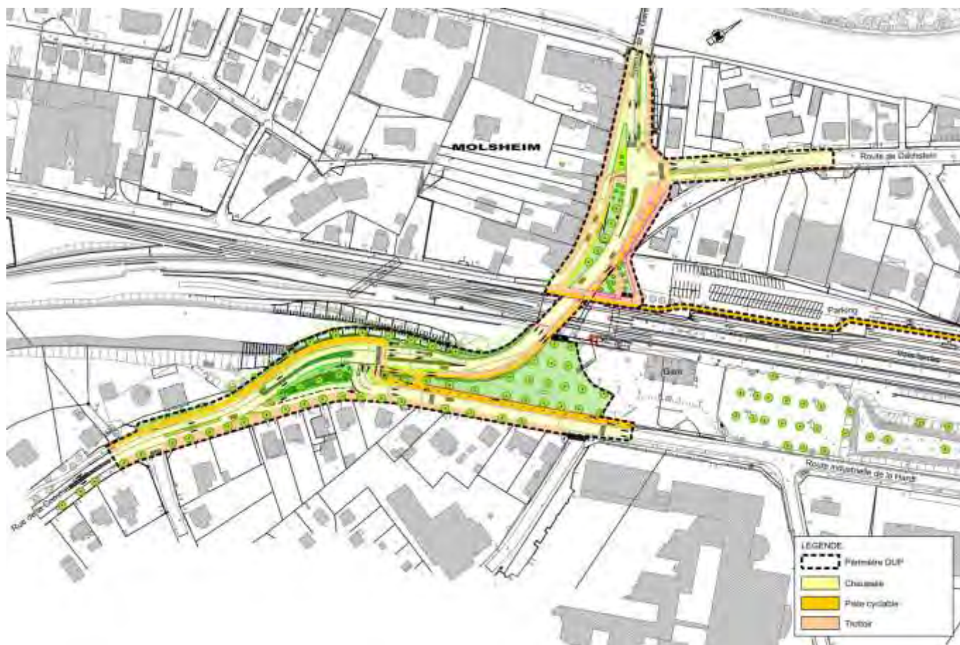
Schéma d'aménagement du passage à niveau avec intégration de pistes cyclables
