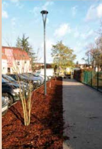
La technique du double paillage a été adoptée pour la plantation des arbres. Sur une bâche biodégradable a été déposée une couche de mulch.
