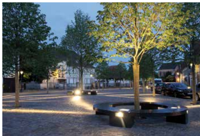
Des blocs optiques de type Led ont été fixés sur les nouvelles banquettes circulaires destinées à agrémenter l'espace arboré de la place.
